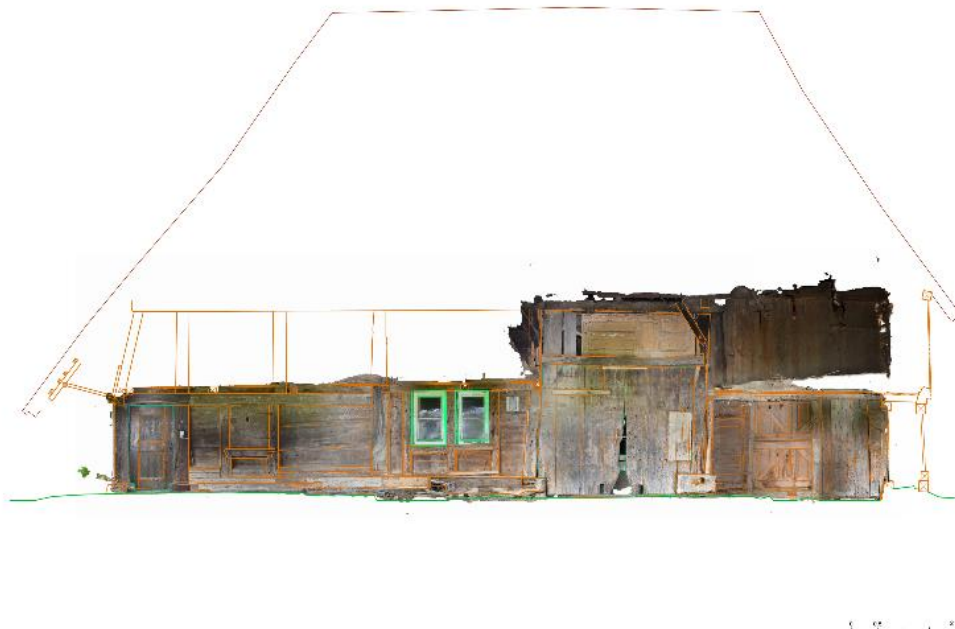
Abb. 6 Fassade mit eingefügtem Orthophotomosaik (mit Agisoft Metashape generiert).
