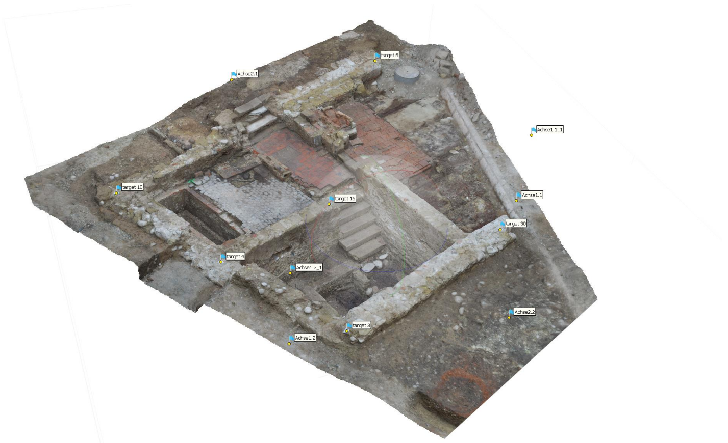
Abb. 4 Dichte Punktwolke in Metashape. (Abb.: Kantonsarchäologie Aargau, S. Dietiker)
