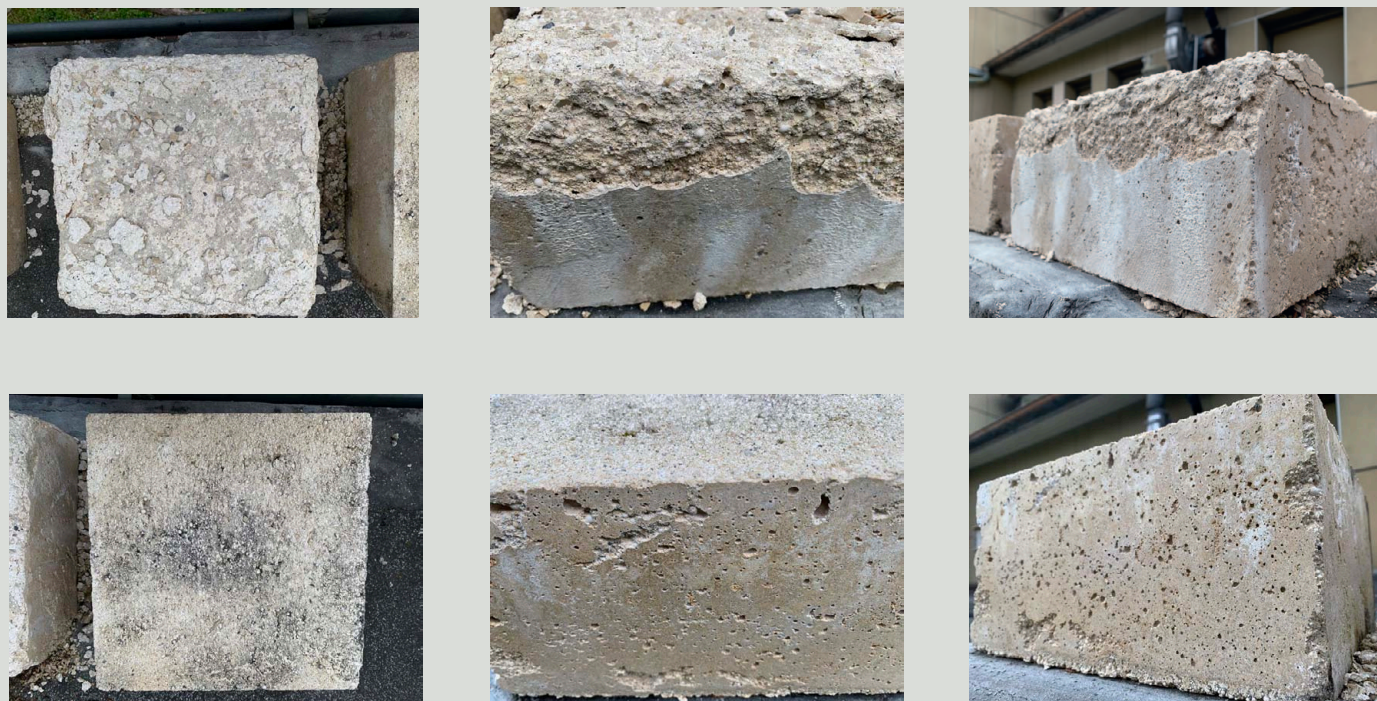
Fig. 6 : Éprouvettes après six ans de vieillissement, exposées aux intempéries ; sans métakaolin (ligne du haut) et avec métakaolin (ligne du bas). © Site et Musée romains d'Avenches
