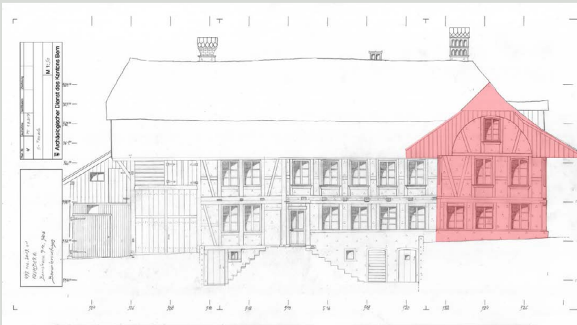
Abb. 3: Ansicht Südfassade einer Töpferei aus Heimberg BE. Sie datiert archivalisch wie auch dendrochronologisch ins Jahr 1805/06 und wurde in den Jahren 2019 am aufgehenden Bauwerk und nach dem Abbruch des Gebäudes 2021 im Boden untersucht. Rot das ursprüngliche Töpferhaus um 1805/06. © Pierre Eichenberger, Archäologischer Dienst Bern
